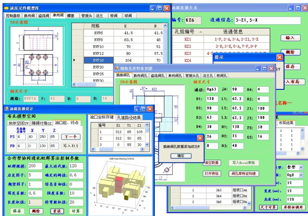
图 6 液压集成块参数化 CAD 系统软件界面
