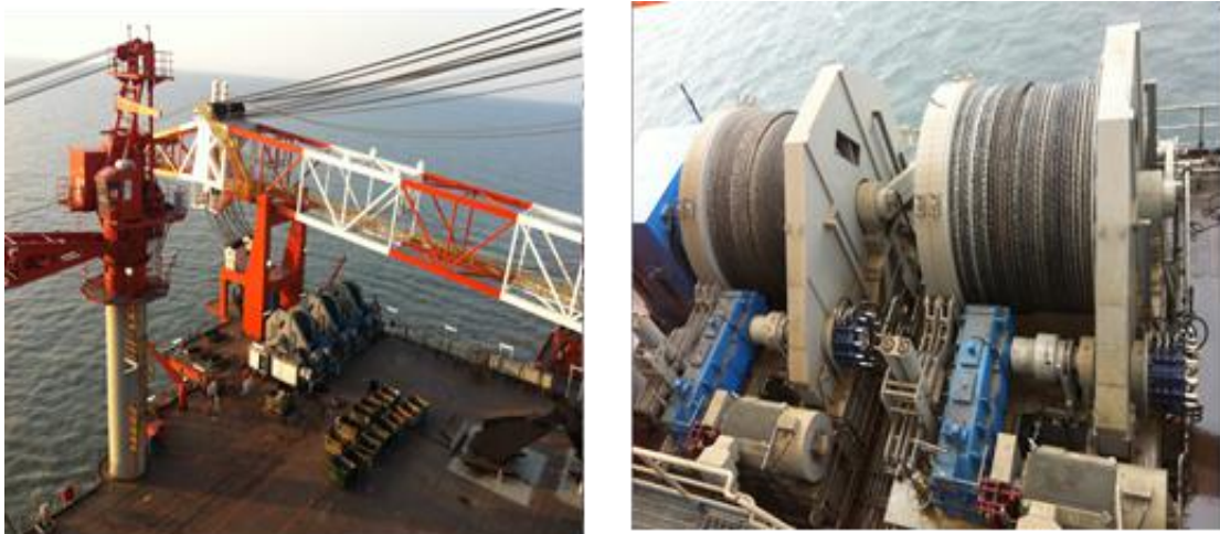
图 1 深海作业平台绿色节能锚泊定位智能装备
